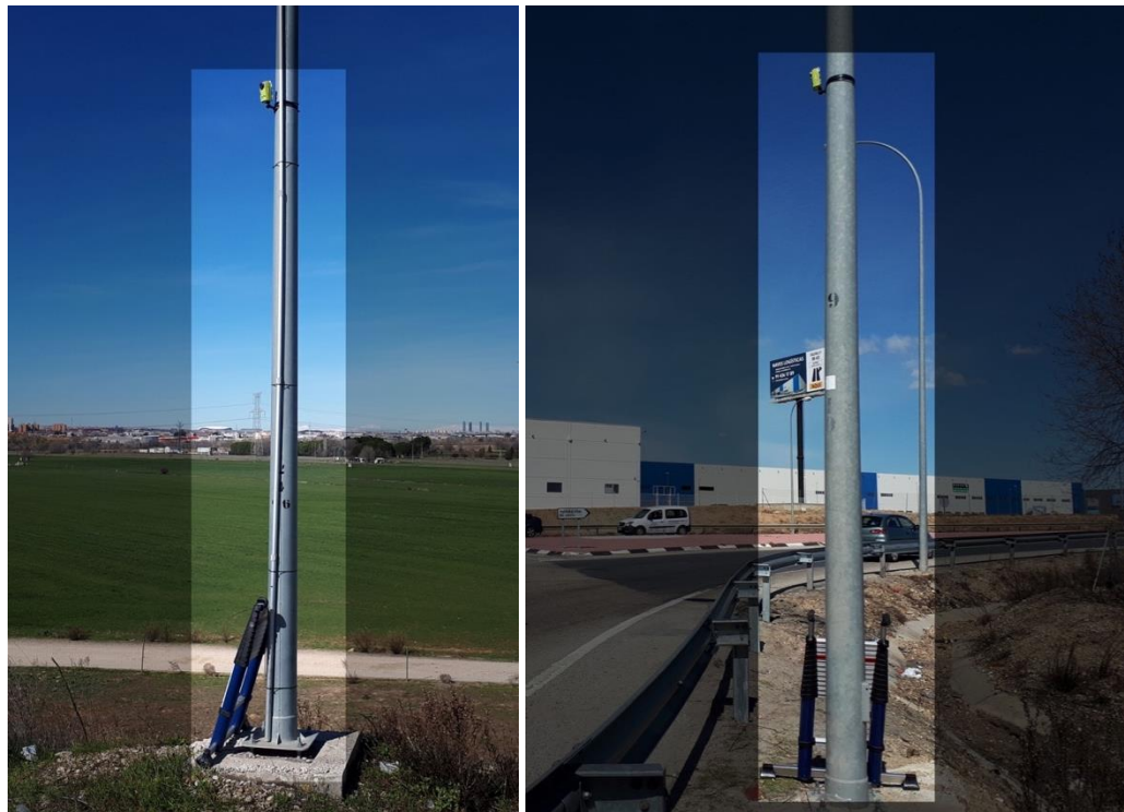
Imagen 7. Aforos de tecnología de visión artificial ubicados en distintos puntos del entorno de estudio.
