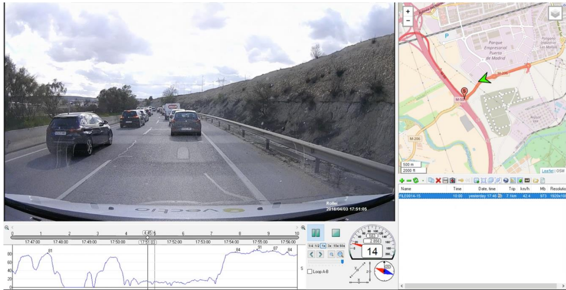
Imagen 9. Procesamiento en gabinete de los itinerarios con cámara embarcada georeferenciada.
