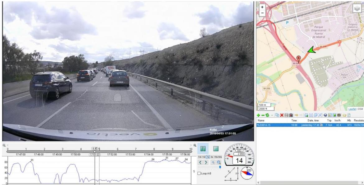
Imagen 9. Procesamiento en gabinete de los itinerarios con cámara embarcada georeferenciada.
